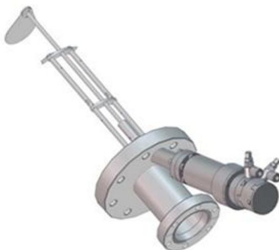
Рисунок 1.8 – Изображение строения заслонки эффузионного источника третьей группы
