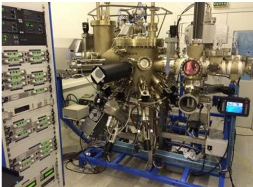
Рисунок 1.1 – Установка молекулярно-пучковой эпитаксии RIBER Compact 21
